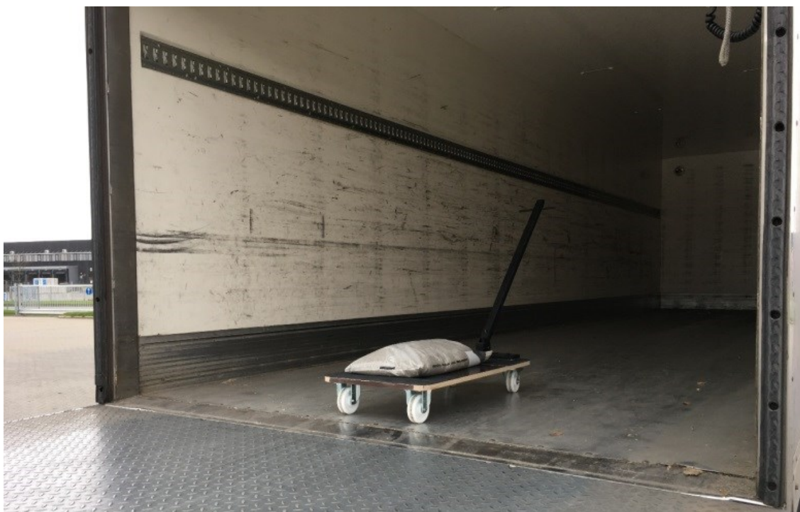
Figur 10. Måleopstilling med "Modified Roll Container" placeret på vognbunden i vognkasse.
