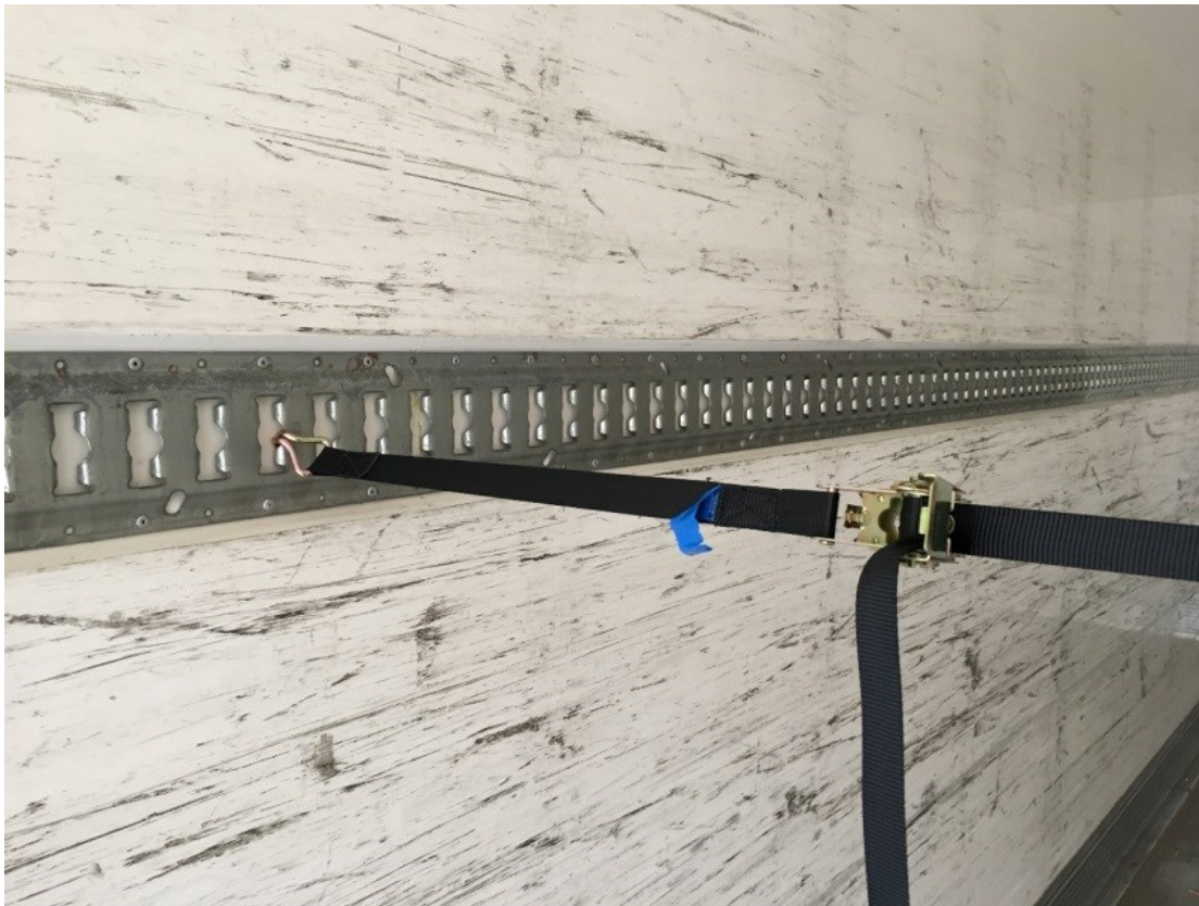
Figur 11. Måleopstilling med laststrop placeret i lastskinner i vognkassens sider.
