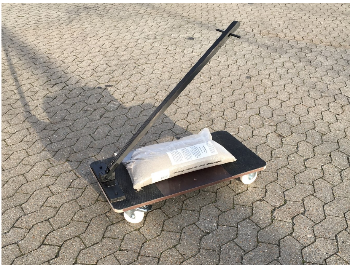
Figur 4. "Quiet modified roll container" med 100 mm hårde plasthjul og en 25 kg's sandsæk
