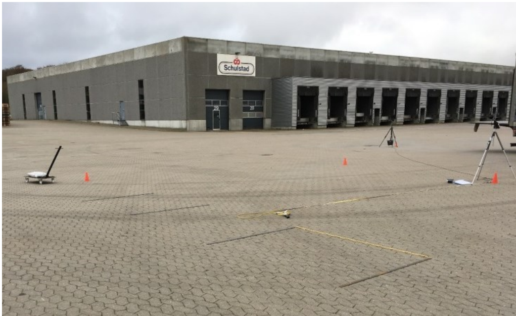
Figur 12. Måleopstilling for måling af rullestøj fra transportmateriel med 5 mm tykke stålskiner udlagt pr. 2 meter
