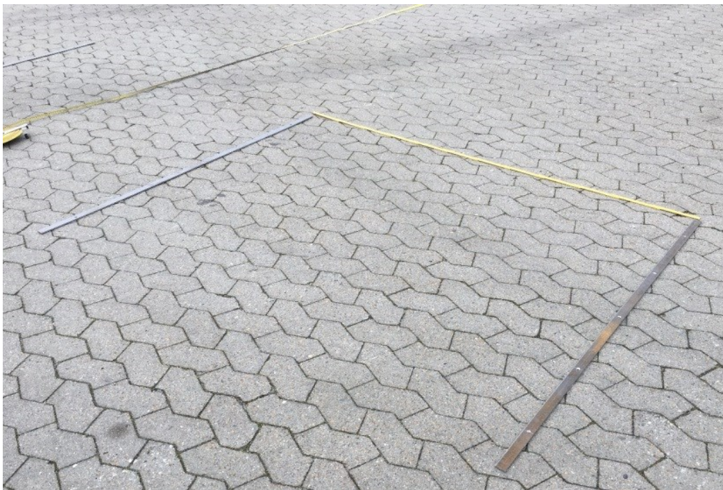
Figur 13. Stålskiner fastgjort med kamsøm til belægningen
