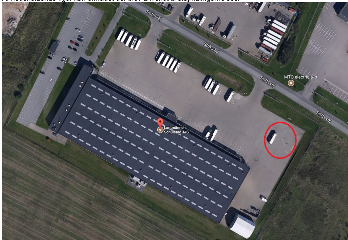
Figur 1. Område anvendt til støjmålinger (Lantmännen Schulstad, Stiftsvej 10, Vejle). Der er målt øst for lastbilen og det var også her at banen for rullestøj blev etableret på belægningen. Belægningen er udført som SF-sten med smalle og fyldte fuger. Der blev i alle tilfælde målt 1,2 meter over et akustisk hårdt terræn (i dette tilfælde SF-betonbelægningssten) i et område uden betydende refleksioner fra bygninger eller andre genstande (såkaldt frit felt).
